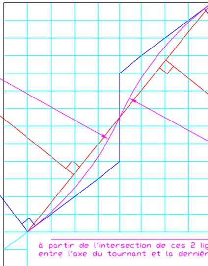
à partir de l'intersection de ces 2 lignes, tracer un arc de cercle entre l'axe du tournant et la dernière marche à balancer
