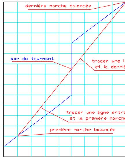
tracer une ligne entre l'axe du tournant et la dernière marche à balancer
